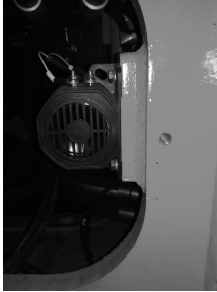
Рисунок 60 Гудок предупредительной сигнализации о движение задним ходом (задний щиток снят)
