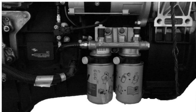
1 – сменные фильтры тонкой очистки топлива; 2 – дренажная трубка; 3 – дренажный винт
