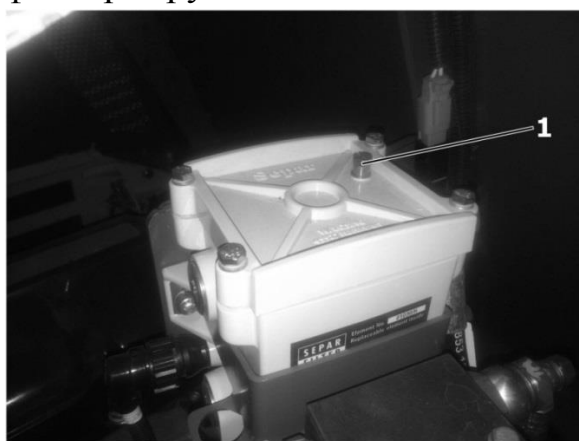
Рисунок 155 Воздушный клапан фильтра грубой очистки топлива
