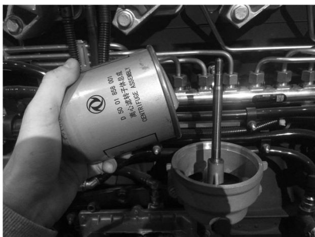
Рисунок 134 Сменный патрон фильтра центробежной очистки масла
