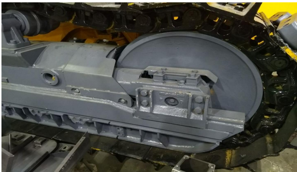
Рисунок 195 Направляющая система подвески направляющего колеса
