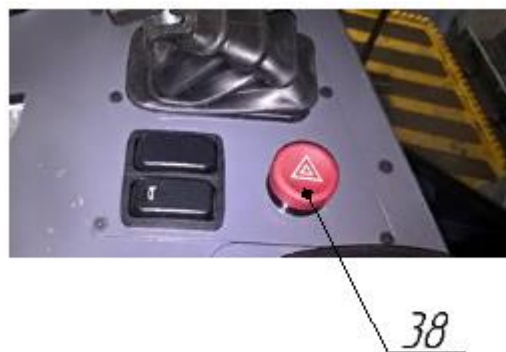
Рисунок 34 Аварийный ударный выключатель
