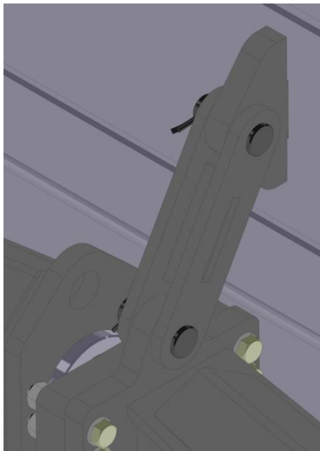
Рисунок 94 Монтаж центральной тяги
