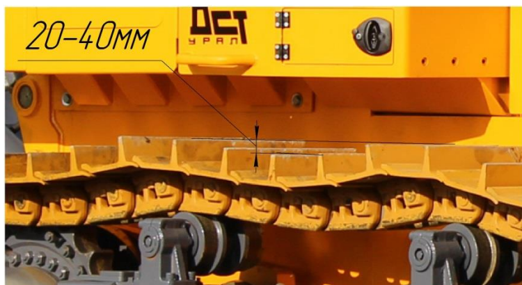
Рисунок 204 Проверка натяжения гусениц
