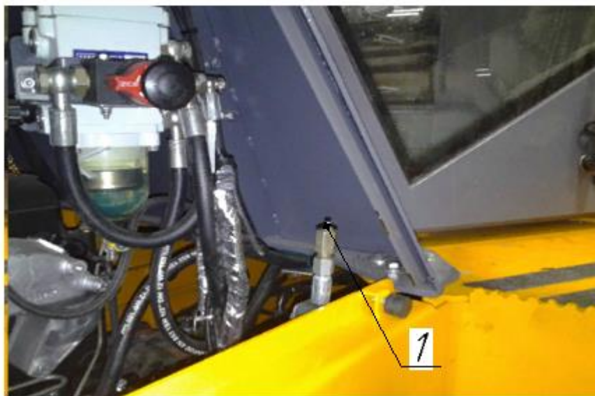
Рисунок 223 Точка смазки оси балансирной балки
