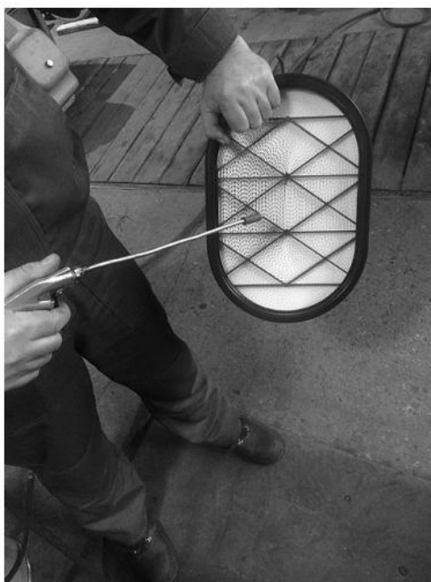
Рисунок 160 Продувка главного фильтрующего элемента
