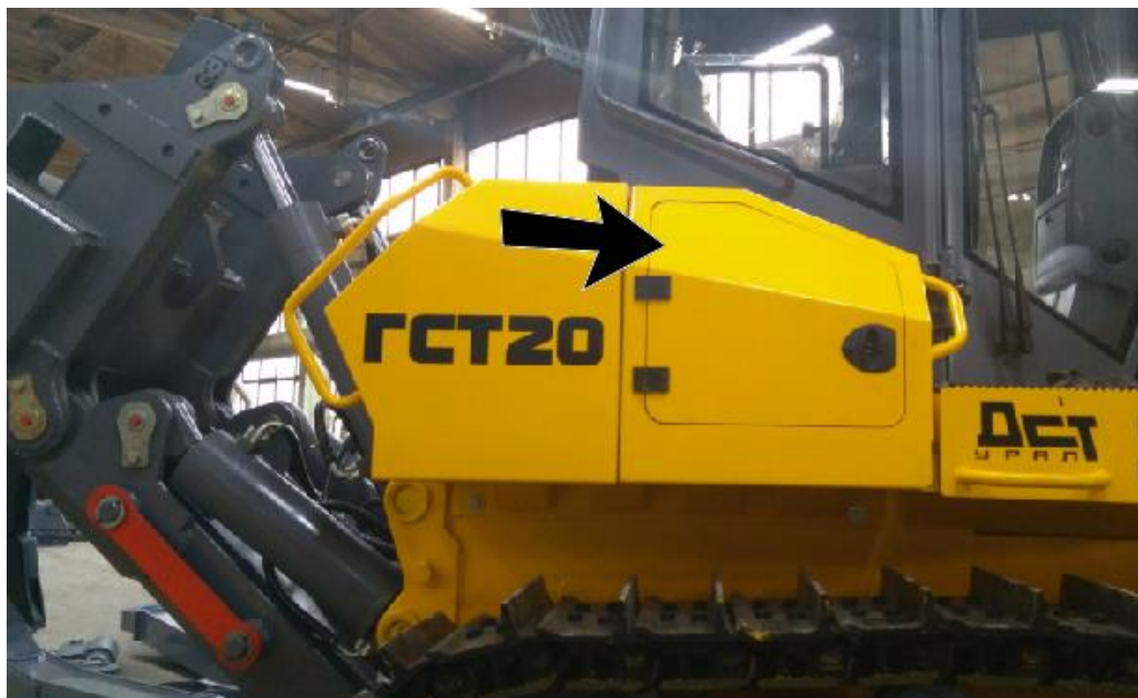
Рисунок 183 Ящик с аккумуляторными батареями
