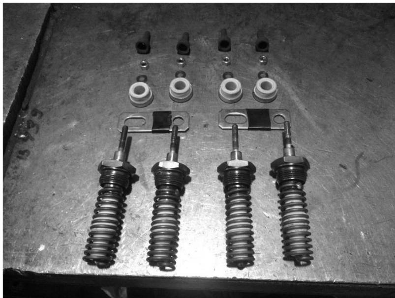
Рисунок 140 Свечи подогрева воздуха в разборе
