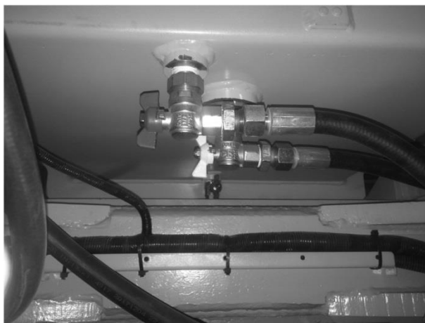
Рисунок 147 Запорные краны системы питания топливом
