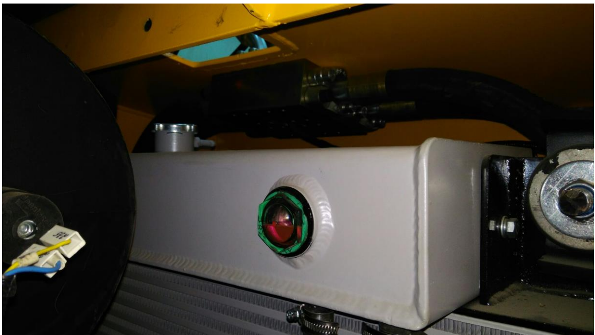
Рисунок 141 бачок охлаждающей жидкости и указатель уровня жидкости
