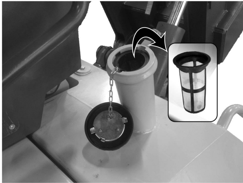
Рисунок 151 Заливная горловина и сетка топливного бака
