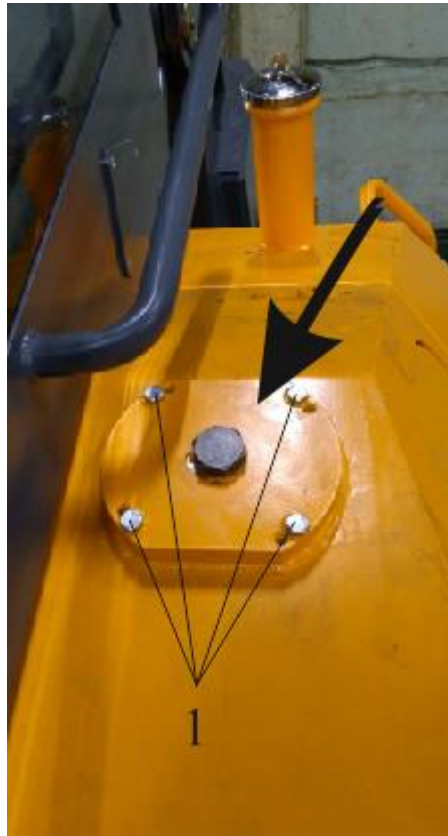
Рисунок 176 – Место заправки гидравлическим маслом
